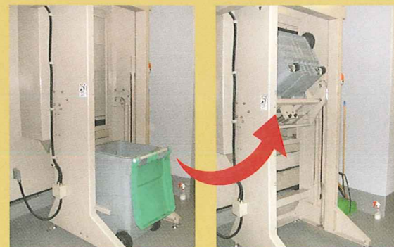
③自動反転投入型 専用のゴミ容器を所定の位置にセットすれば、あとは自動的に容器を持ち上げ反転し、内容物を投入します。キャスター付きの専用容器は移動も容易。労力を省き、作業の安全性を高めます。
