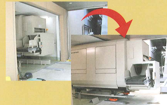
③移動装置 ゴミ収集車とのドッキングに問題が生じる場合、この装置で問題のない場所までゴミックを移動することが可能。地下駐車場など、ゴミ収集に車路を利用する場合に適しています。
